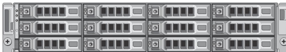
図 2. DR Series システム拡張シェルフ (MD1200) のドライブスロットの場所
